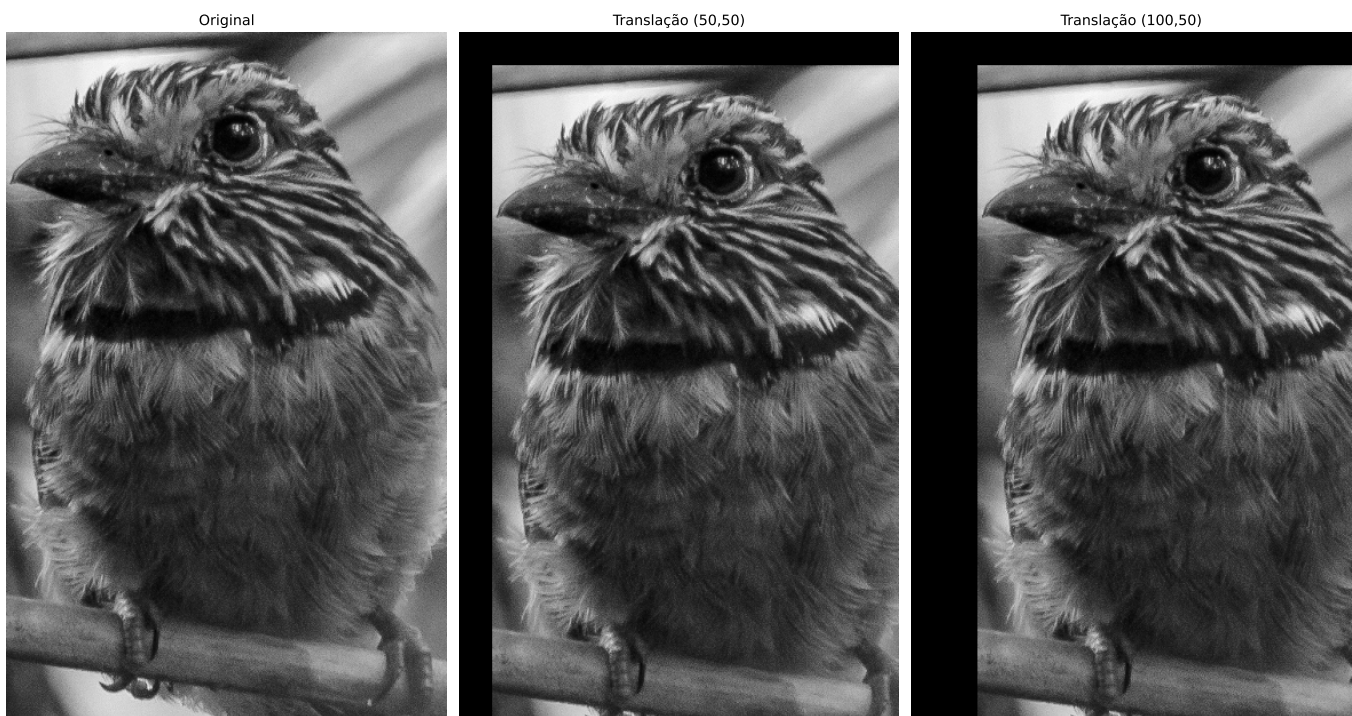
Figure 2.8: Exemplo de translação da imagem do pássaro com deslocamentos (50,50) e (100,50).
