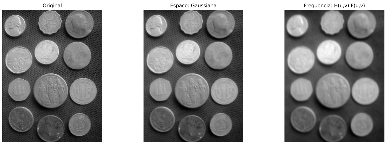
Figure 5.9: Teorema da Convolução: filtrar no domínio do espaço (Gaussiana) equivale a multiplicar o espectro por H(u, v) na frequência. As saídas coincidem visualmente.
