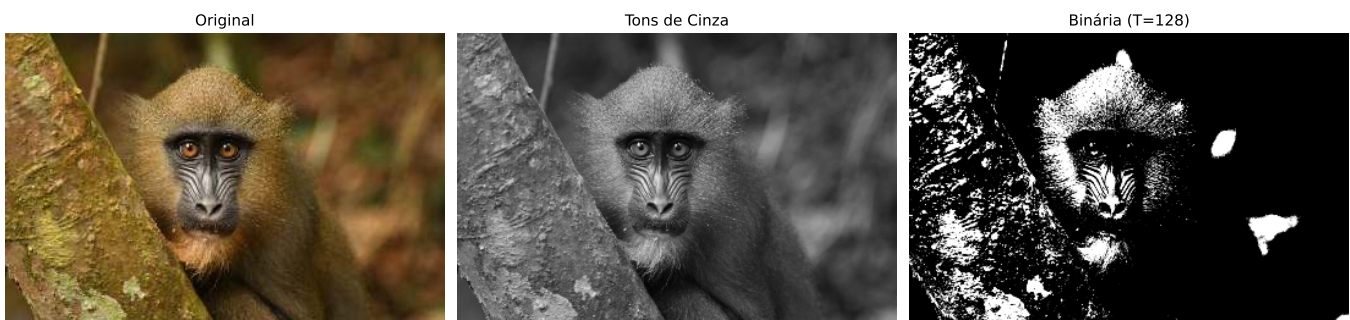
Figure 1.8: Processamento básico de imagens: (a) imagem original, (b) imagem em tons de cinza, (c) imagem binarizada por limiar ( T=128 ).
