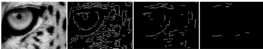
Figure 3.22: Detector de Canny com diferentes pares de limiar: limiares baixos capturam mais bordas (inclusive ruído); limiares altos retêm apenas as bordas mais fortes.
