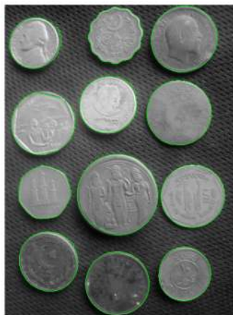
Figure 4.28: Contornos extraídos com findContours . Cada moeda é anotada com sua circularidade — valores próximos de 1 confirmam forma circular.
