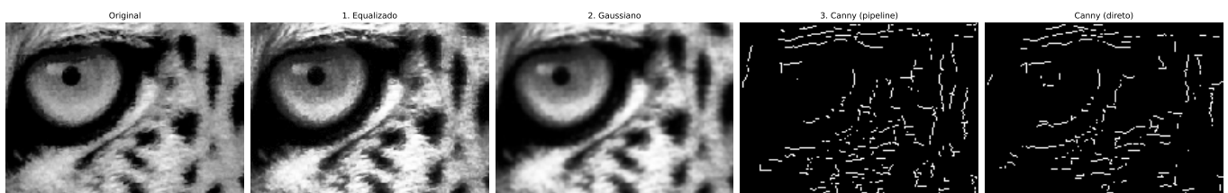
Figure 3.25: Pipeline de pré-processamento: equalização → Gaussiano → Canny. A trilha Python usa CLAHE no lugar da equalização global; CLAHE não tem equivalente em morph.hpp.
