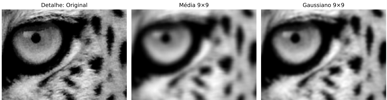
Figure 3.14: Comparação entre filtro de média e Gaussiano ( \text{kernel } 9 \times 9 , \sigma=0 ). O Gaussiano preserva melhor as bordas, visível no detalhe do rosto.
