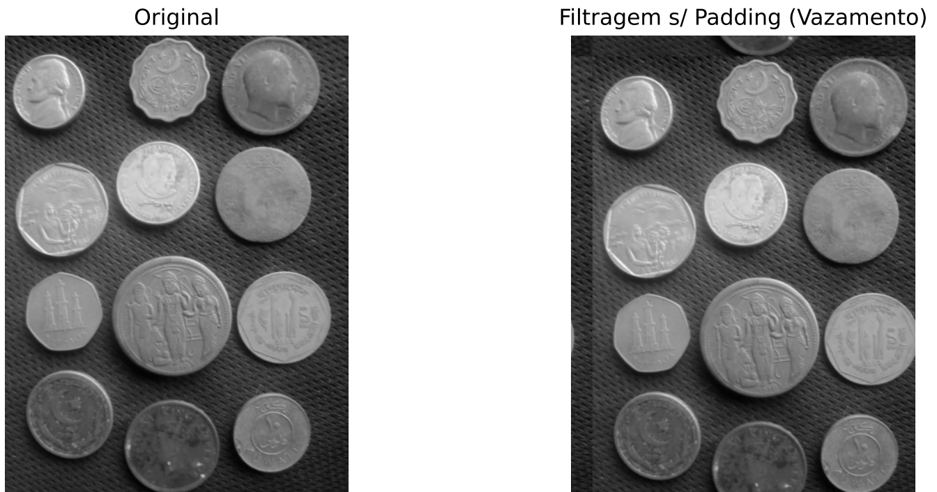
Figure 5.8: Sem padding , um deslocamento severo faz a imagem vazar para o lado oposto (convolução circular).
