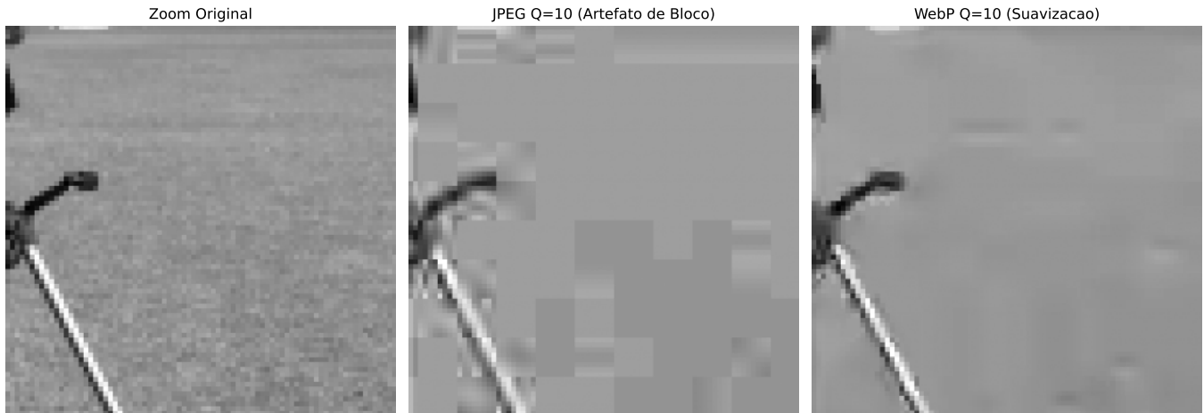
Figure 5.27: Análise comparativa de artefatos de compressão sob fator de qualidade reduzido ( Q = 10 ). À esquerda, observa-se o artefato de bloco característico da discretização por DCT no JPEG. À direita, evidencia-se o efeito de atenuação e suavização de bordas intrínseco ao padrão WebP.
