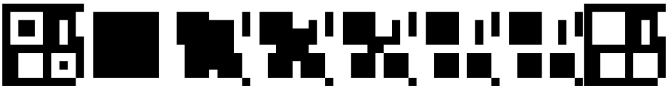
Figure 4.10: Pipeline de preenchimento de buracos ( clohole ): o marcador vem da borda da imagem, restrito ao complemento f^c . A dilatação geodésica reconstrói o fundo externo; após a complementação, os buracos internos ficam preenchidos.
