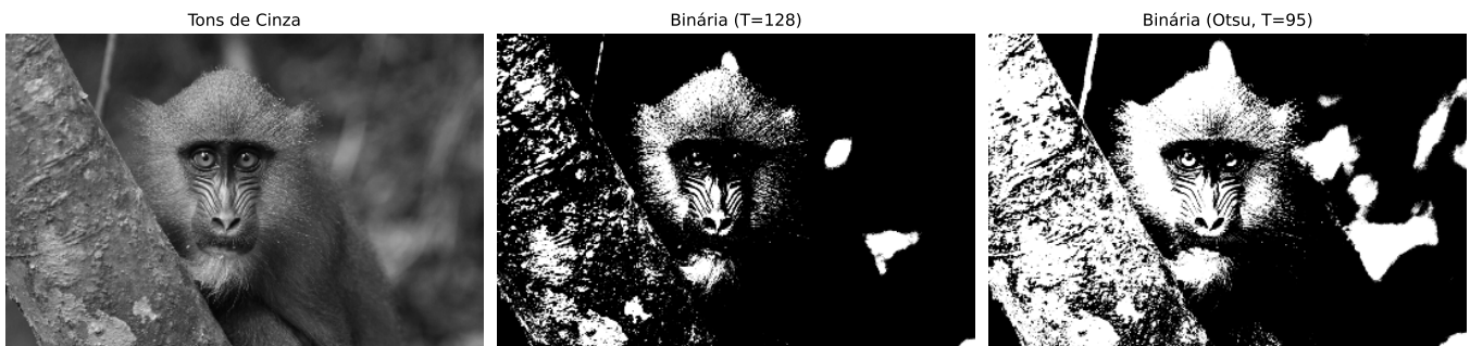
Figure 1.9: Comparação entre limiarização manual ( T=128 ) e automática (Otsu) sobre a imagem em tons de cinza.
