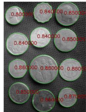
Figure 4.28: Contornos extraídos com findContours . Cada moeda é anotada com sua circularidade — valores próximos de 1 confirmam forma circular.
