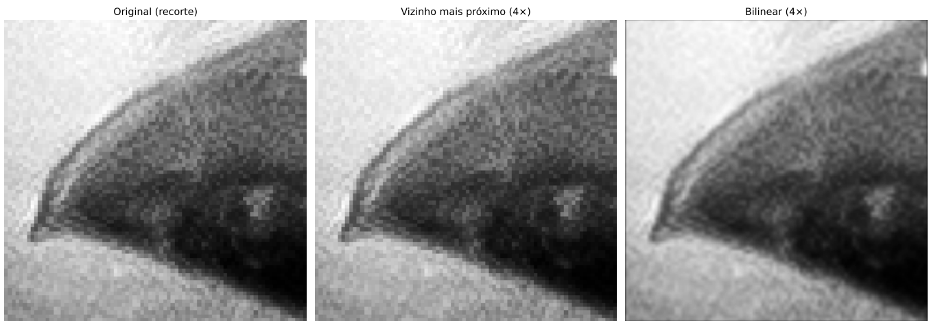
Figura 2.10: Comparação de interpolação com zoom no detalhe do olho (recorte 60×60, ampliado 4×). Note o efeito de blocos no vizinho mais próximo vs. a suavização na bilinear.
