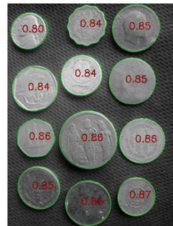
Figura 4.28: Contornos extraídos com findContours . Cada moeda é anotada com sua circularidade — valores próximos de 1 confirmam forma circular.
