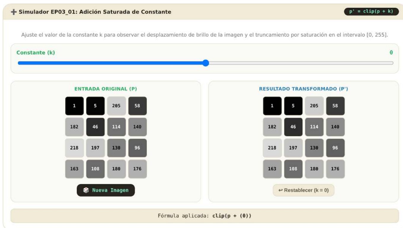
Figura 3.26: Simulador EP03_01: Adición Saturada de Constante ( p' = \text{clip}(p + k) )
