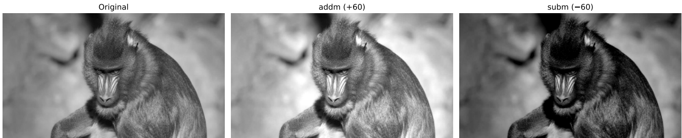
Figura 3.2: Operações aritméticas saturadas: adição de constante (clareamento) e subtração de constante (escurecimento com saturação em 0).
