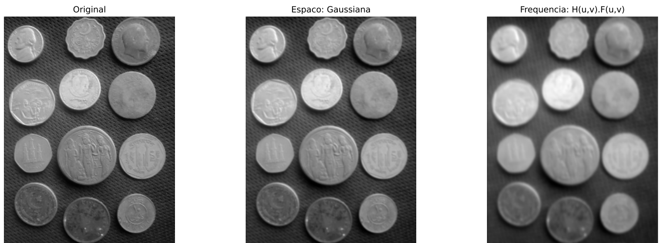
Figura 5.9: Teorema da Convolação: filtrar no domínio do espaço (Gaussiana) equivale a multiplicar o espectro por H(u, v) na frequência. As saídas coincidem visualmente.
