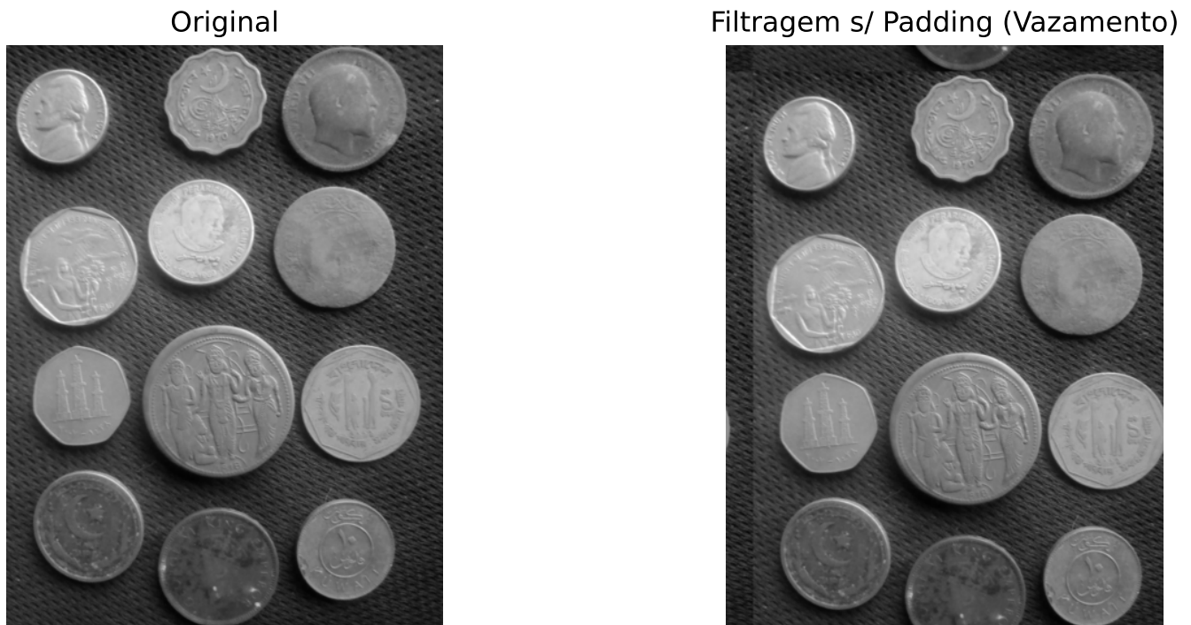
Figura 5.8: Sem padding , um deslocamento severo faz a imagem vazar para o lado oposto (convolução circular).
