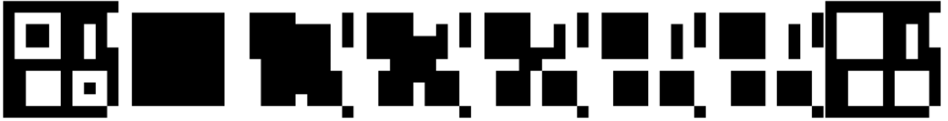
Figura 4.10: Pipeline de preenchimento de buracos ( clohole ): o marcador vem da borda da imagem, restrito ao complemento f^c . A dilatação geodésica reconstrói o fundo externo; após a complementação, os buracos internos ficam preenchidos.
