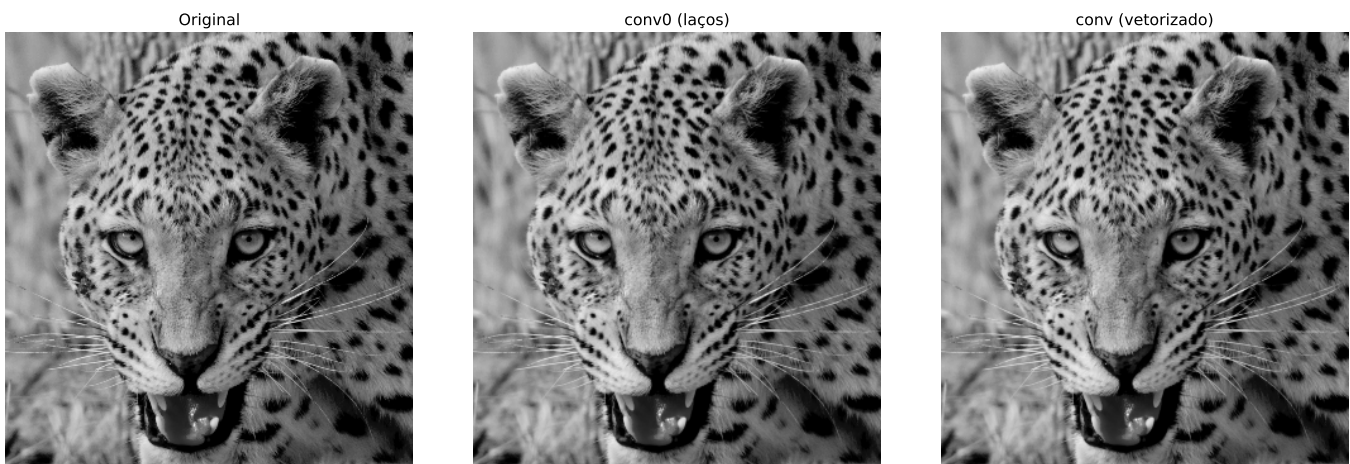
Figura 3.10: Correlação com kernel de média 3 \times 3 : versão didática mm::conv0 (bordas preservadas) vs. mm::conv (borda refletida). A diferença se concentra nas bordas.
