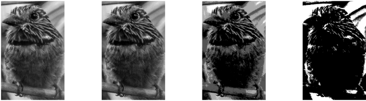
Figure 2.5: Efeito da redução da profundidade de bits. Os títulos exibem a quantidade de bits, níveis e o tamanho em memória (KB).
