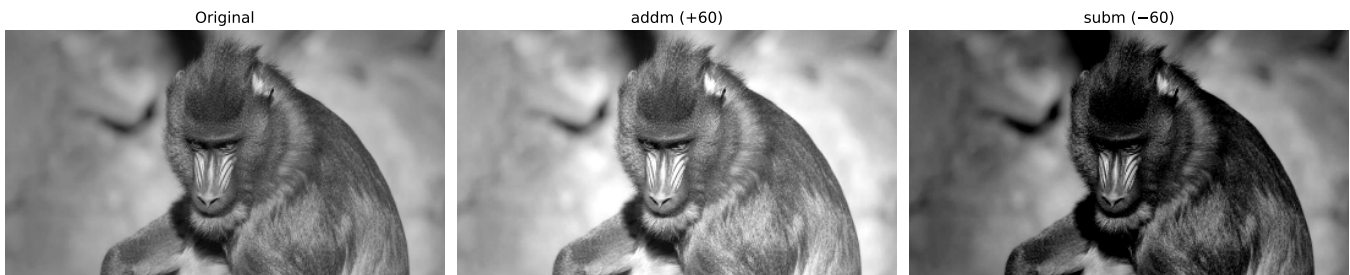
Figure 3.2: Operações aritméticas saturadas: adição de constante (clareamento) e subtração de constante (escurecimento com saturação em 0).
