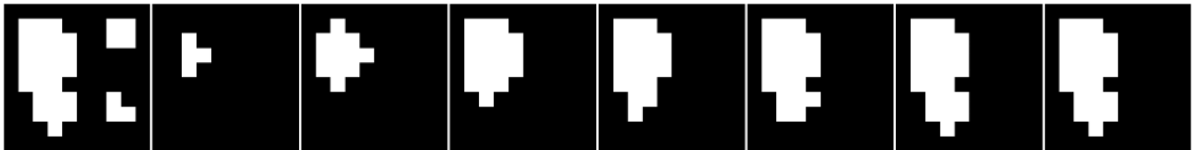
Figure 4.9: Pipeline de Reconstrução Morfológica por Dilatação Condicionada: a máscara contém dois objetos, o marcador isola apenas o núcleo do objeto principal, e as iterações reconstróem sua forma exata até a convergência.
