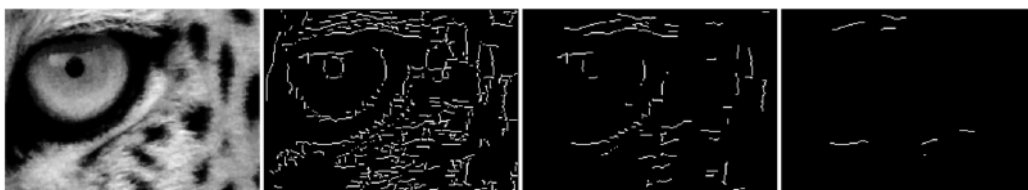
Figure 3.22: Detector de Canny com diferentes pares de limiar: limiares baixos capturam mais bordas (inclusive ruído); limiares altos retêm apenas as bordas mais fortes.
