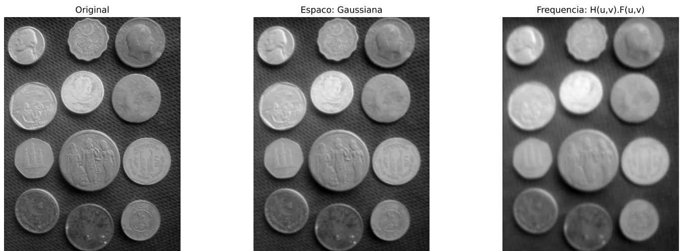
Figure 5.9: Teorema da Convolação: filtrar no domínio do espaço (Gaussiana) equivale a multiplicar o espectro por H(u, v) na frequência. As saídas coincidem visualmente.
