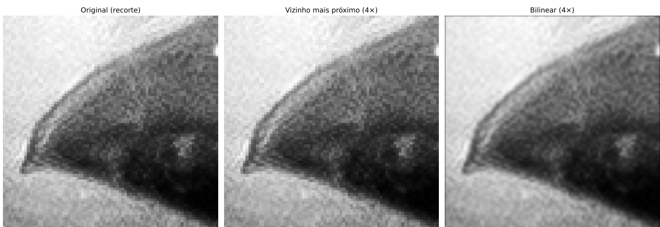
Figure 2.10: Comparação de interpolação com zoom no detalhe do olho (recorte 60×60, ampliado 4×). Note o efeito de blocos no vizinho mais próximo vs. a suavização na bilinear.
