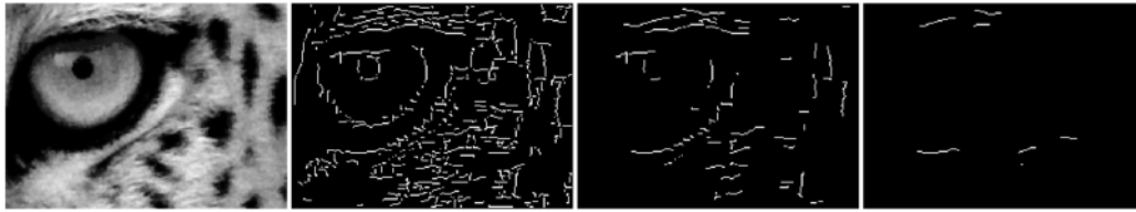
Figura 3.22: Detector de Canny com diferentes pares de limiar: limiares baixos capturam mais bordas (inclusive ruído); limiares altos retêm apenas as bordas mais fortes.
