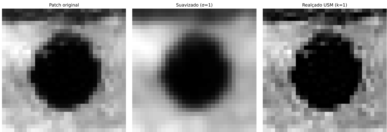
Figura 3.20: Realce por Unsharp Masking num patch do leopardo: mm::usm faz suavização Gaussiana, subtrai da original (máscara de alta frequência) e reintroduz a máscara realçada.
