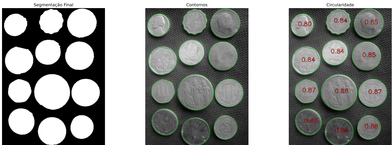
Figura 4.28: Contornos extraídos com findContours . Cada moeda é anotada com sua circularidade — valores próximos de 1 confirmam forma circular.
