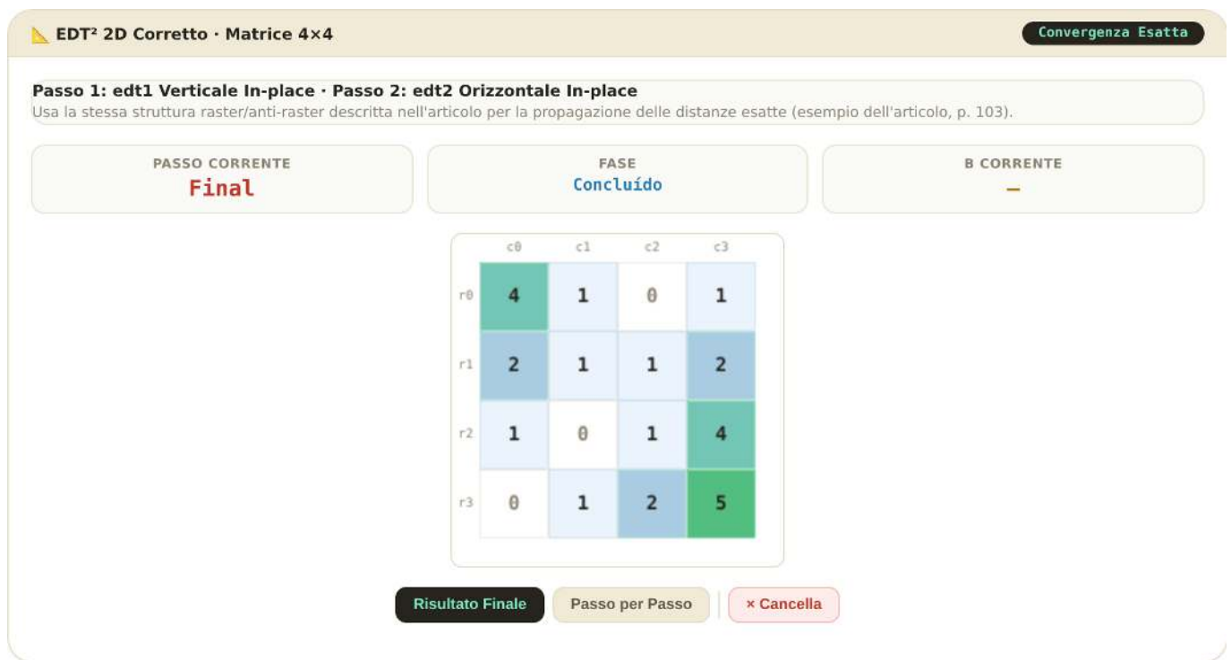
Figura 4.21: Simulatore interattivo 2D (4x4) com sincronização rigorosa das codes de propagação horizontal (b) para obter a convergência exata descrita no artigo.
