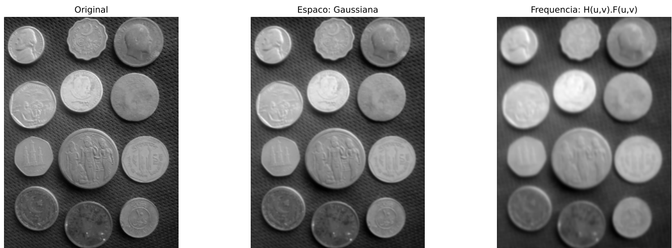
Figura 5.9: Teorema da Convolução: filtrar no domínio do espaço (Gaussiana) equivale a multiplicar o espectro por H(u, v) na frequência. As saídas coincidem visualmente.
