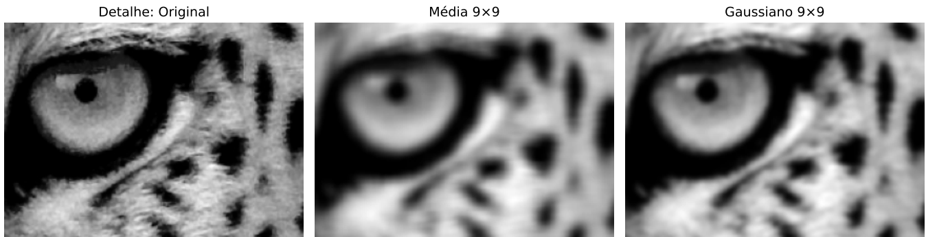
Figura 3.14: Comparação entre filtro de média e Gaussiano ( kernel 9×9, \sigma=0 ). O Gaussiano preserva melhor as bordas, visível no detalhe do rosto.
