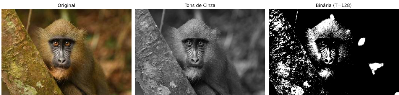
Figura 1.8: Processamento básico de imagens: (a) imagem original, (b) imagem em tons de cinza, (c) imagem binarizada por limiar ( T=128 ).
