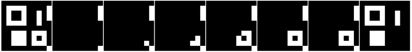
Figura 4.11: Pipeline de eliminação de estruturas de borda ( edgeoff ): o marcador captura as raízes conectadas às extremidades, a reconstrução delimita esses elementos e a subtração preserva só os objetos totalmente internos.
