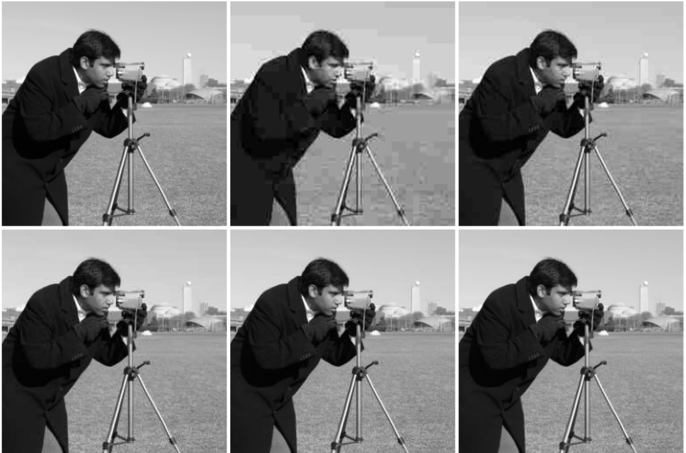
Figura 5.25: Pipeline JPEG simplificado aplicado à imagem clássica do Cameraman : DCT em blocos 8 \times 8 , quantização com diferentes fatores de qualidade e reconstrução via IDCT. Os artefatos de bloco ( blocking artifacts ) tornam-se visualmente evidentes em fatores de qualidade reduzidos ( Q = 10 e Q = 25 ).
