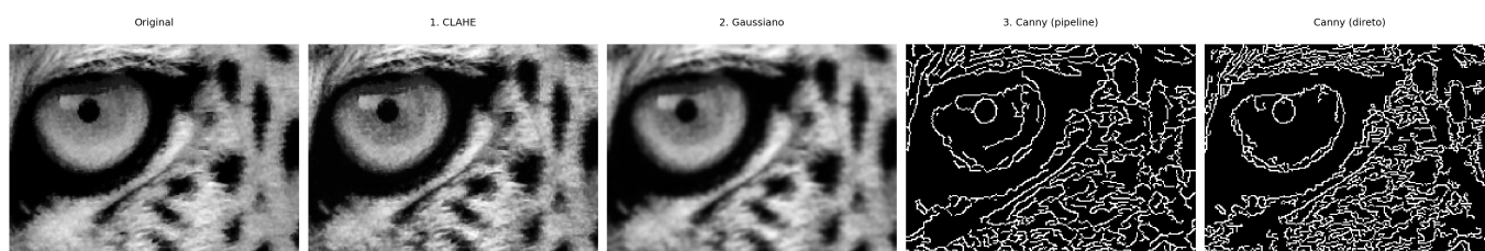
Figura 3.21: Pipeline de pré-processamento: CLAHE → Gaussiano → Canny. Cada etapa prepara a imagem para a seguinte, resultando em bordas limpas e bem definidas.
