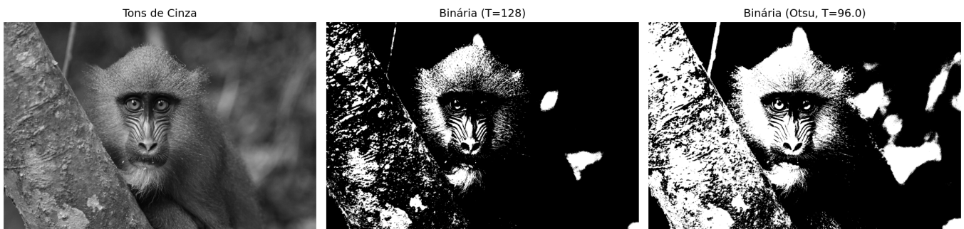
Figura 1.9: Comparação entre limiarização manual (T=128) e automática (Otsu) sobre a imagem em tons de cinza.
