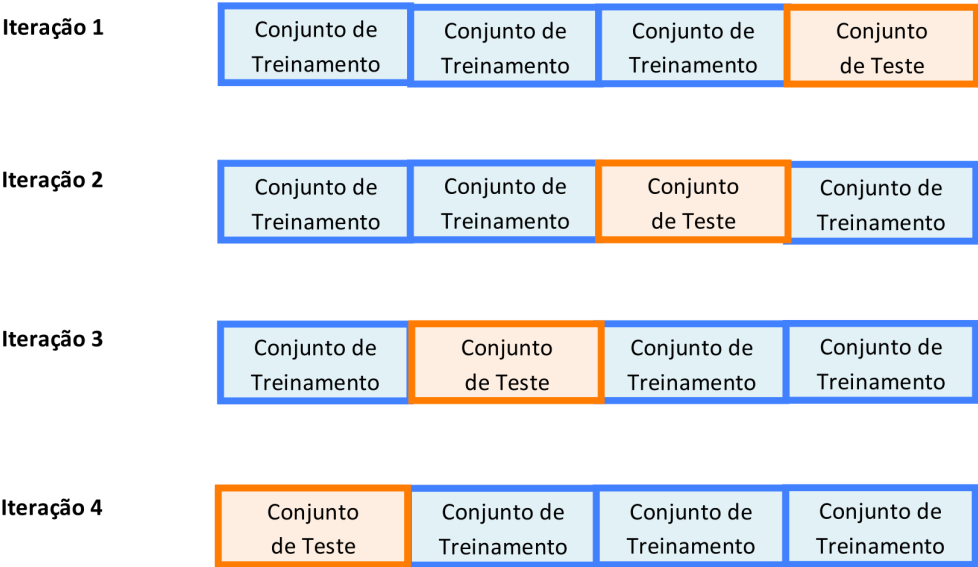
Figura 4.4: Na Validação Cruzada, o Conjunto de Treinamento é Dividido em k Partições.
